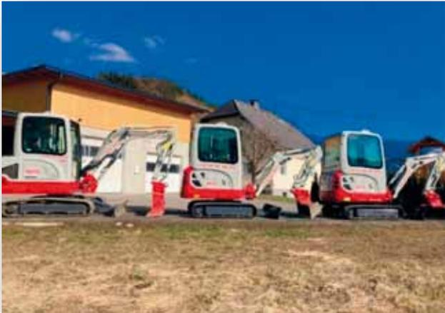
Zur Verfügung stehen drei neue Takeuchi Minibagger mit hydraulischen Schnellwechslern. mehr aussteigen beim Löffel wechseln und es ist jeder Löffel schwenkbar durch das Powertilt. Bagger: TB216: 1800 kg u. TB225: 2500 kg mit diversen Anbaugeräten wie z.B. Erdbohrer, Hydromeisel usw.
