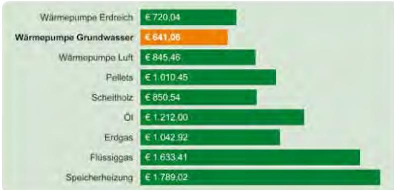
Saniertes Altbau: 130 m<sup>2</sup>; Heizleistung 8,25 kW; gut gedämmt; Radiatorenheizung
